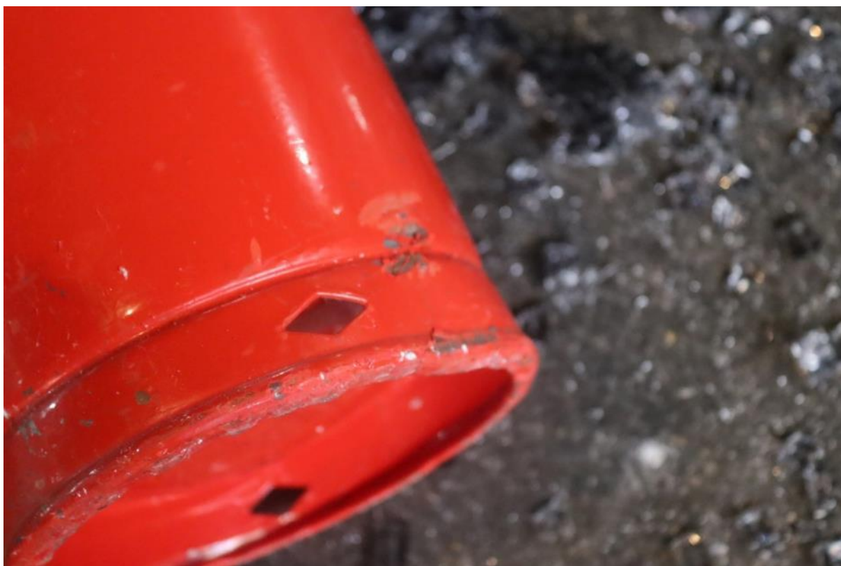
Fotografia 25 – Amassamento na base do extintor, compatível com impacto contra anteparo/superfície rígida.
